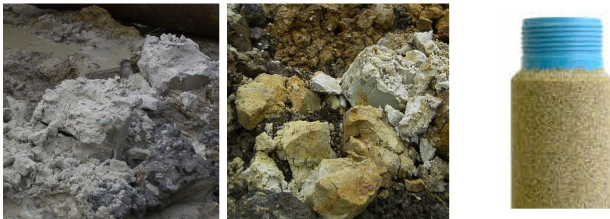
Obrázek č. 17 Výnos horninového jádra z vrtu HVB-3 – santonské pískovce a lepené filtry použité pro výstroj vrtu
