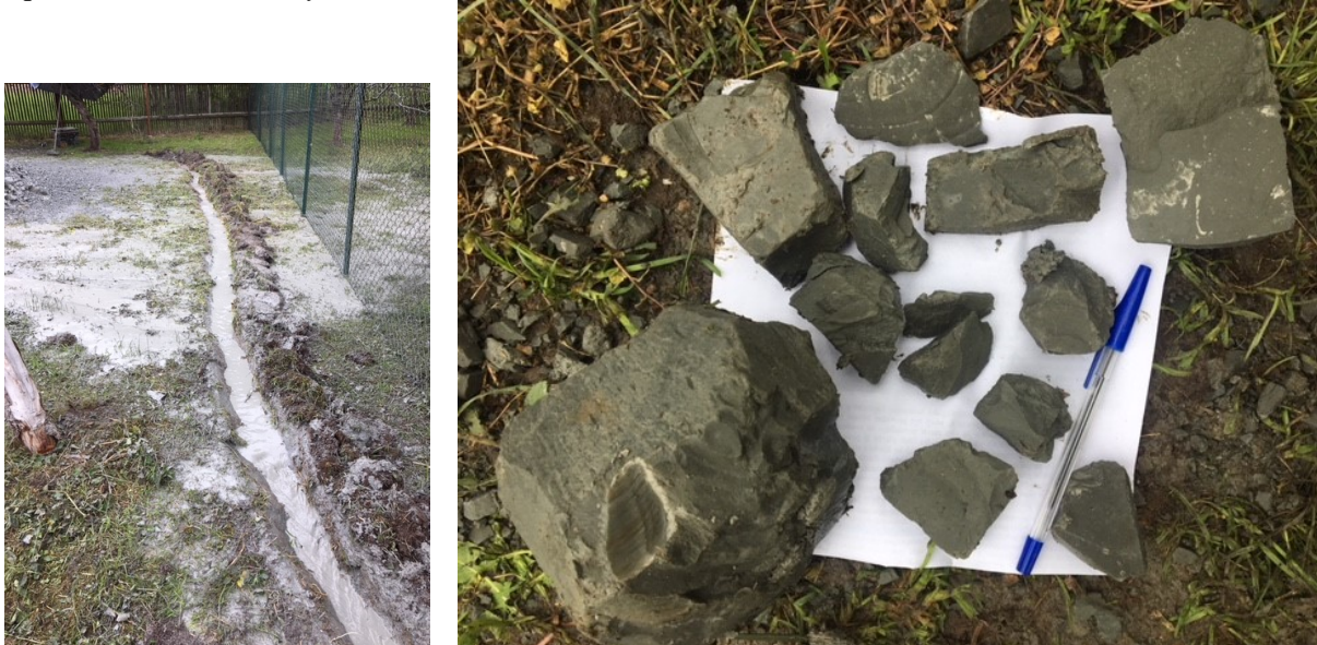
Obrázek č. 10 Výplach z vrtu o vydatnosti cca 3 - 4 l/s a kostkovitě rozpadavé slínovce z hloubky 46 – 56 m o průměru až 14 cm, místy s limonitickými povlaky
